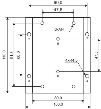
Furos 1, 2, 3 e 4: Para fixação do dissipador no fundo do painel / 1, 2, 3 and 4 holes: For heat sink panel mount
