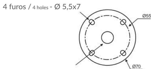
Passagem de cabo / Cable passage -  $\varnothing 18$
