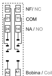
\* Para correntes > 10 A, os terminais de contato devem ser conectados em paralelo (21 com 11, 24 com 14, 22 com 12).
