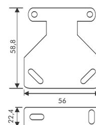
Suporte de instalação fornecido com sensor.
