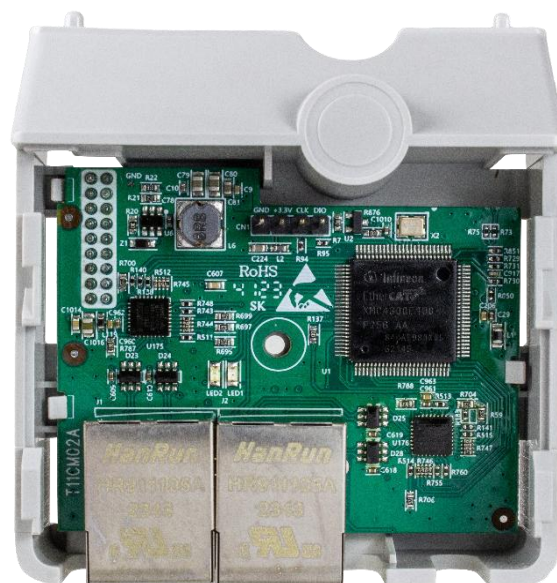
IF30-CAN Módulo de comunicación EtherCAT
