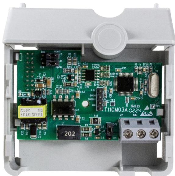
IF30-CAN Módulo de comunicación CANOpen
