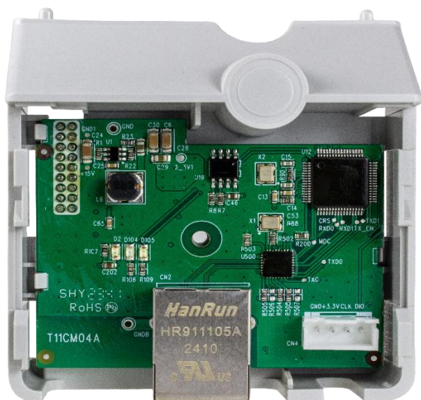
IF30-MTCP Módulo de comunicación MODBUS TCP
