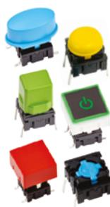
▶ Interruptores PTH o SMD, 10x10mm, h=8,5mm, curso de 1,0mm, contacto NA o NA/NC momentáneo hasta 50mA/24V. Vida eléctrica de 10M ciclos (versión NA) o 1M ciclos (versión NA/NC). Protección IP67. Fuerza de operación 200gf, 350gf (estándar) o 650gf. Opción de versión silenciosa en 200gf. Versiones simples sin LED. Versiones con chip LED integrado - 5 opciones de colores y hasta modelos bicolors.
