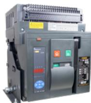
Disyuntor tripolar fijo de caja abierta. Modelos para corrientes de 630 a 4000A y tensión de hasta 690VCA. Capacidad de interrupción de hasta 100kA-400VCA. Incorpora controlador inteligente de fácil configuración.
