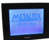
IHM 5,7" con 4.096 colores TFT LED. Resolución 320 x 240 pixels. Touch screen. Frontal con protección IP67 y UV. Reloj/calendario y tarjeta SD. Comunicación RS232-24VCC. AIG32TQ03DE.
