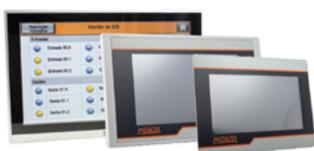
Interface Hombre-Máquina gráfica colorida con pantalla sensible al toque de alta precisión. Disponible en las dimensiones 4.3", 7", 10.2" y 15". Posee puerto serial RS232/485/422 con modelos disponibles con puerto Ethernet. Comunicación con diversidad de PLCs y otros equipos del mercado. Puerto de programación USB. Alimentación 24VCC. Software de programación gratuito MPT Studio. Excelente costo/beneficio. Disponible con monitoreo vía red LAN.
