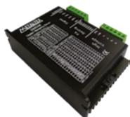
Drive digital para motor de paso de 2 fases con alimentación de 20 a 50VCC y corriente de salida entre 2 y 5,6A seleccionable por conmutador. Posee entradas de 5V de pulso, dirección e inhibición. Función micro paso con resolución entre 200 y 40.000 pasos por revolución del motor. Función PID adaptable online.
